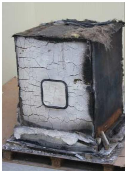
FireShelter после испытания >60 мин. при 1200°C/2000°F
